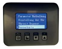
Das System erlaubt die Einstellung der Regenerationszeit nach Uhrzeit und/oder Wasserhärtegrad.
